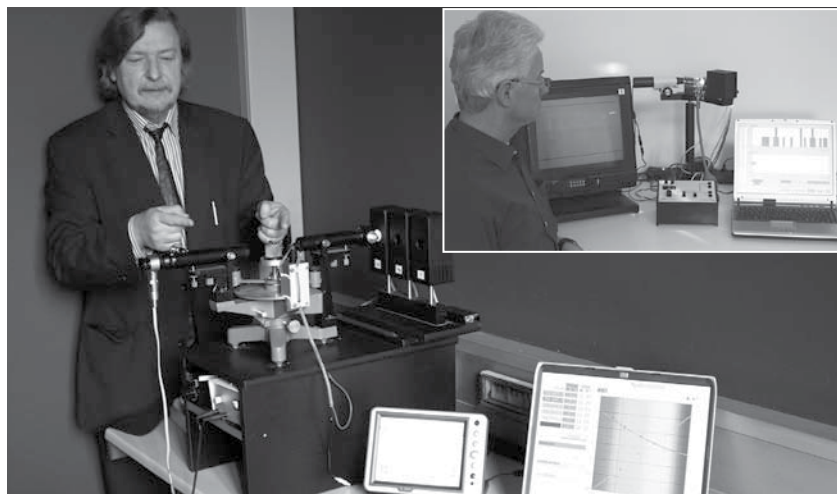
Großes Foto: Prof. Dieter Sprengel identifiziert ein unbekanntes Gas mit dem Spektrometer. Kleines Foto: Günther Burkschat, Mitarbeiter im Labor, bei der Untersuchung geladener Öltröpfchen.
