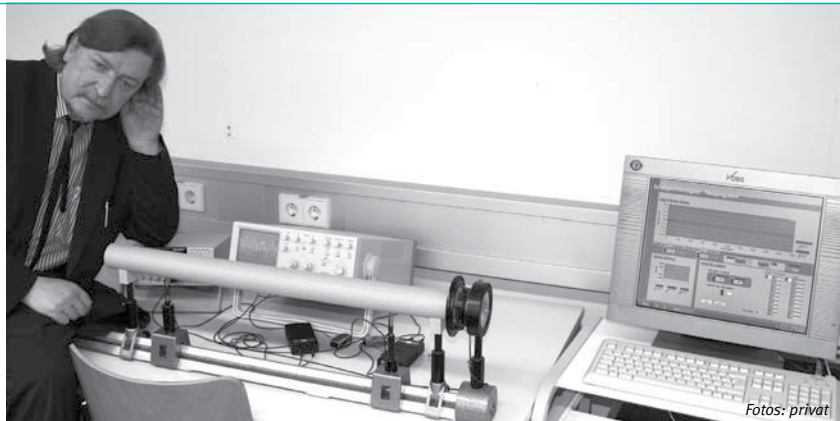
Im Physikkolabor wird die Schallgeschwindigkeit in der Luft mit verschiedenen Methoden bestimmt. Für das Foto auch mal mit dem Ohr.
